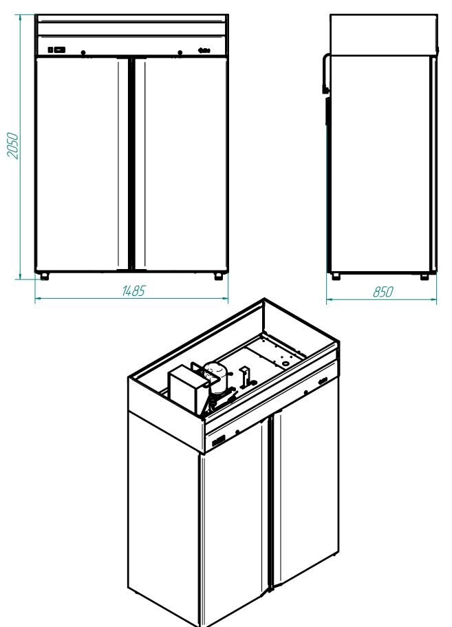
Шкаф холодильный типа ШХ-1,4 (ШХн-1,4;ШХс-1,4) с верхним расположением агрегата предназначен для хранения пищевых продуктов в охлаждённом или замороженном состоянии на предприягиях общественного питания и торговли.
